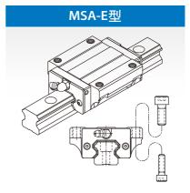
除了可从滑块的上面进行装配外,同时又适用 于工作台无法开安装螺栓用贯穿孔的状况下, 从滑块的底面往上进行装配。
