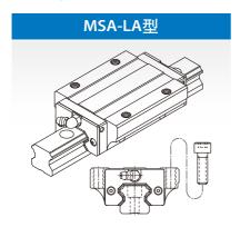
与MSA-A型具有相同断面尺寸,增加滑块的长度,并增加负荷钢珠数,提升整体的负荷能力。
